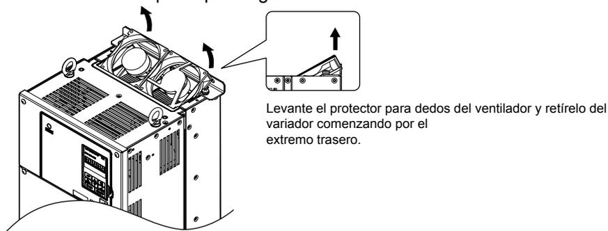
Figura 7.9 Quite el ventilador de enfriamiento: 2A0110, 2A0138, 4A0058, 4A0072, 5A0041 y 5A0052
